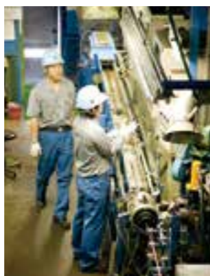
絶縁工程。裸の銅線が絶縁体で被覆されるまで、機械は止まることはない
