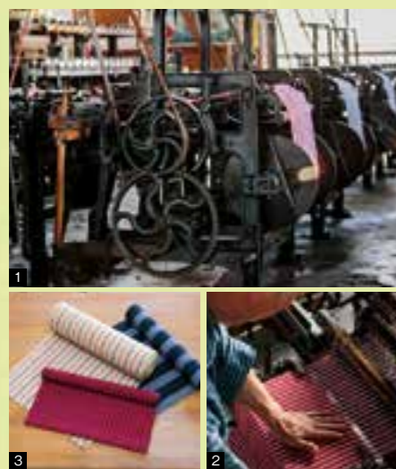
1. 豊田式鉄製小幅動力織機 (Y式)。1世紀の時を経て、今も現役で動いている 2. 織りの状態を目と手で確かめる。糸が切れそうな状態など、異変を瞬時に見極める 3. 縞模様が特徴の若柳地織。7色の綿糸を組み合わせ、さまざまなパターンで織り上げる
