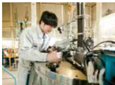
サファイア単結晶の作成装置。研究所と結晶センターでは、約20台の結晶作成装置が稼働している
