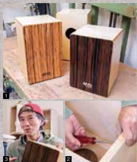
1. 打面の木目が美しいカホン。反対側には円形の穴が開いている 2. 打面の裏側となる部分にスナッピーと呼ばれる金属(写真)やギター用の弦などを取り付ける。打面の先端をたたくとジャラジャラという金属音も一緒に発する 3. 電器商会と音楽スタジオを営んでいる青沼さん。ものづくりと音楽の原点がそこにあると話す
