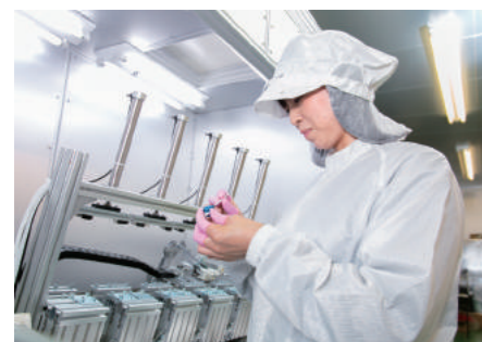
袋詰めされる直前の製品を抽出し、光ファイバのコネクタを使って、品質を確かめる
