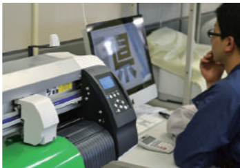
作成した文字やデザイン通りにシートを切り抜く「カッティングプロッタ」の操作は、看板屋にとって必要不可欠な技術だ
