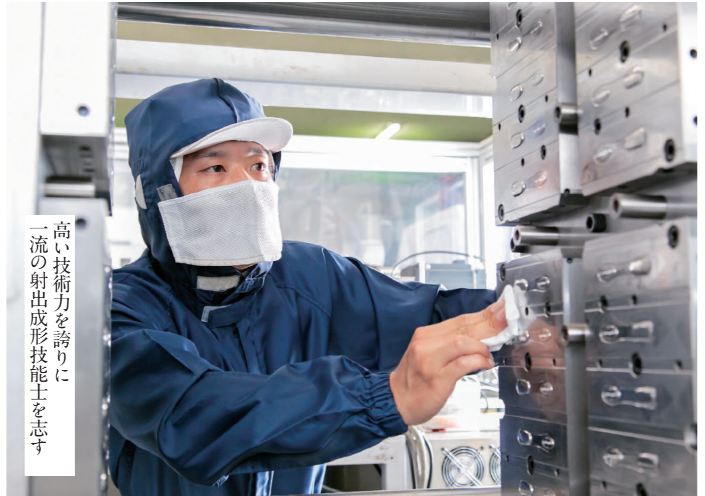
プラスチック射出成形機に装着された金型の汚れをふき取る宗形隼也さん
