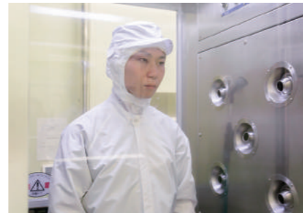
防塵服に着替え、エアシャワーを浴びてから工場の中に入る。手洗いの後にアルコール消毒をするなど、衛生管理を徹底して行う
