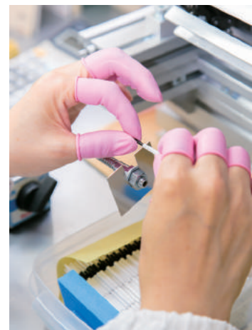
不織布と柄を取り付ける。製品開発の際には、柄との接合部に不織布をどれくらい深さまで差し込むか、微調整が繰り返された
