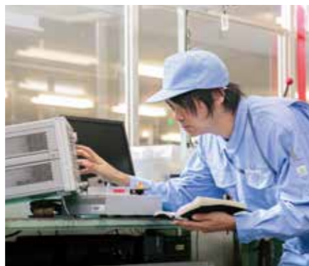
製品の「透磁率」を測定する。磁化の状態を表す透磁率は、バスタレイドの信頼性を左右する重要なデータだ
