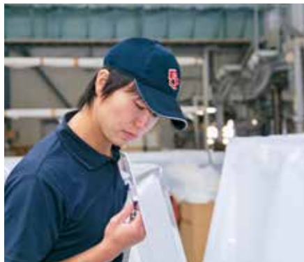
この日初めて成型した製品の品質をチェックする。細かいキズを見逃さないように、ペンライトを当てて確認する
