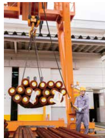
クレーンを使って材料の鋼材を吊り上げる。鋼材はレール上を動く台車によって工場内に運ばれる
