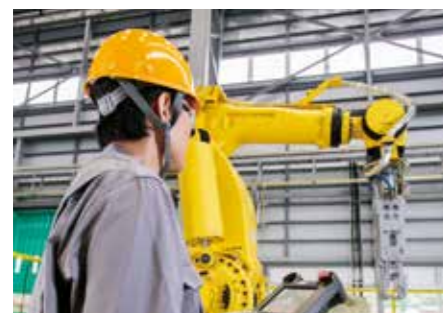
大型の鍛造品の移動は、ロボットアームが自動で行う。アームの動作は、あらかじめプログラムを登録してコントロールする
