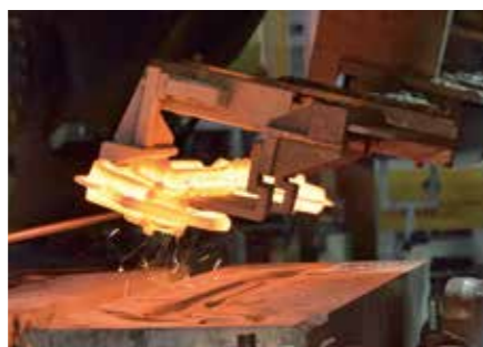
成形されたばかりの製品に空気を吹き付け、表面の「スケール」を除去する。この作業が、製品の良し悪しに影響を及ぼす
