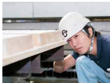
木型を交換。型がプレス機へ正確に取り付けられているか目で確かめる
