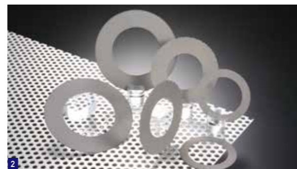
1 担当者と製造の進捗状況を確認する川副秀俊さん。「フレンドリーで話しやすい」と同僚から信頼されている 2 磁気ヘッド加工用砥石の一つ「DCC ブレード」。自社開発のボンド材にダイヤモンド粒子を混ぜ合わせて焼き固め、高剛性、高硬度の薄刃化を実現した
