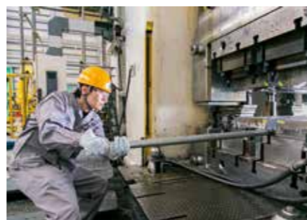
スクリュープレス機に金型を取り付ける。全身の力を使ってボルトをしっかりと固定する
