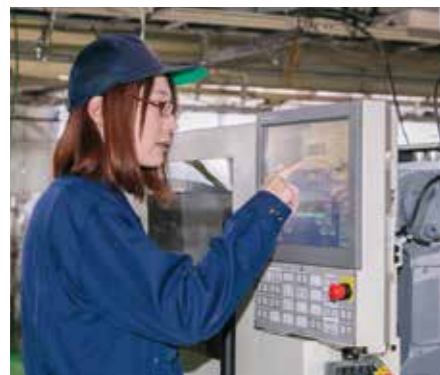
加工した金型を射出成形機にセットして試作する。試作も金型設計者の仕事の一つ
