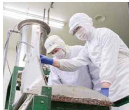
小麦粉に水と食塩を加えて機械でこねる。中の状態を確認しながら、こねる時間や水の分量を見極める
