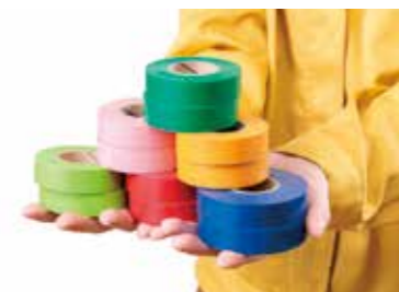
電線のまとまりの目印になるテープも、様々な色が使われる。ワイヤーハーネスづくりでは、用途ごとに指定された「色」を覚えるのも仕事だ
