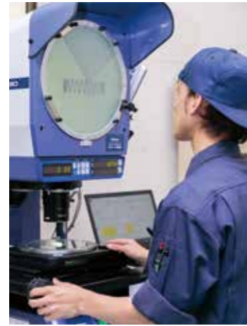
加工した製品を抜き取り検査する。大きさや巻きの間隔など、仕様通りにできているかチェックする
