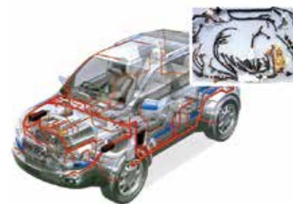
エアコンやカーナビ、ライトのほかに、エンジンを動かすときも電気が必要。そのため、ワイヤーハーネスは、自動車の隅々に張り巡らされている
