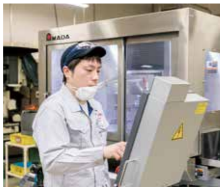
吉田さんは、NC研削盤も扱う。NCとは数値制御（numerically control）のことで、工具の移動距離や速度などをコンピュータで制御する
