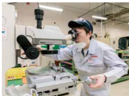
仕上げた製品に傷などがないか確認する。最終的な検査工程に出す前に、自らの目で確かめる
