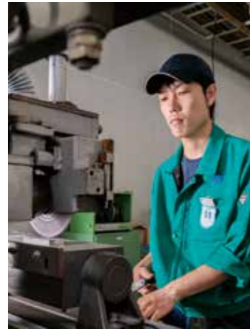
汎用研削盤を操作する。長年関わってきた思い入れのある作業だ
