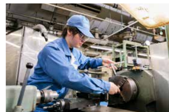
旋盤に加工する金属をセットする。半沢さんは、生産管理部に異動した現在も、製造部門からの要請があれば応援に駆け付けている
