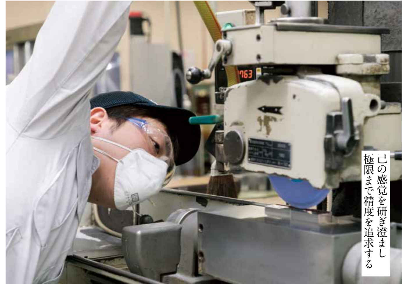
汎用研削盤に工作物をセットし、砥石の高さを調節する吉田大佑さん
