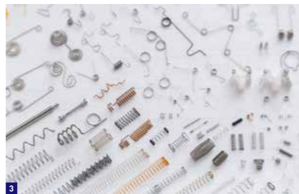
1 コイルマシンのセッティングをする本郷拓真さん。ばねの材料となる金属線やコイルするために必要な工具をマシンに取り付けた後、動作確認をしながら入念に調整を行う 2 マシンで加工され姿を見せる文房具に使われる精密ばね 3 同社で製造する精密ばねの一部。ばねの大きさや形状、使われる金属線の種類は様々
