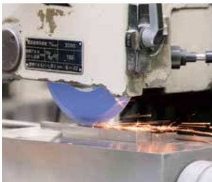
汎用研削盤の砥石によって金属が削られる。発生する火花の状態を見極めながら作業を進める
