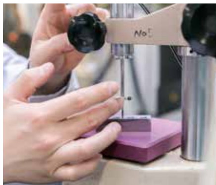
測定器の針に工作物を当て、寸法を確認する。要求された数値になるまで加工と測定を繰り返す
