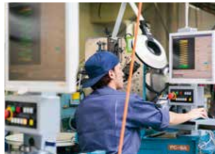
コイルングマシンを操作する。もう一台のマシン(左手前)の状況も気にしながら2台のマシンを操る
