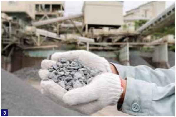
1 40トンオフロードダンプトラックに乗り込む佐藤知之さん 2 死角が多い大型オフロードダンプで安全に走行するため、常に緊張感をもって運転する 3 道路工事に使う主力製品。同工場では、粒の大きさや品質が異なる十数種類の砕石を生産し、お客様の多様なニーズに応えている
