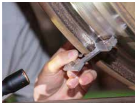
車輪の厚さを特殊な測定器具を使って計測し、ゆがみなどがいないか確かめる
