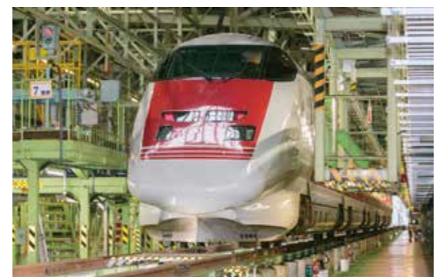
同センターでは、新幹線の軌道・電気設備・信号設備を検査する「East-i」の交番検査も行。東海道・山陽新幹線で活躍する「ドクターイエロー」同様、めったに見ることのできない車両である
