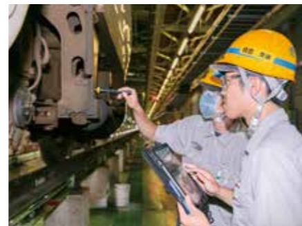
交換部品を取り付けた後は、見落としが無いように2人の検査員が目目チェックする
