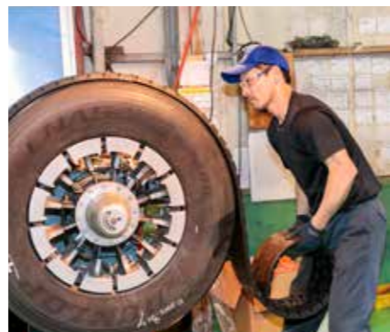
台タイヤとトレッドゴムの接着面には、あらかじめ接着剤が吹き付けてある。貼付け工程では、加熱前の仮止めが行われる
