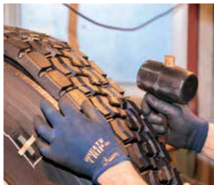
溝のパターンがずれないようにゴムのつなぎ目を貼り合わせる。熱による収縮を考慮して少し余裕を持たせる
