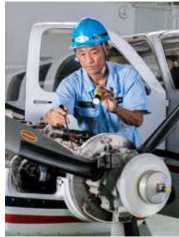
プロペラを動かすエンジンを覆うカバーを外して、エンジンの状態を点検する
