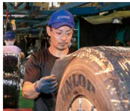
トレッドゴムの表面を保護するために、透明なシートをかぶせて、貼付け工程の作業は完了する
