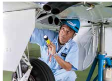
車輪の取り付け部分をライトで照らし、目視で状態を点検する
