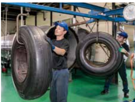
加熱した製品を圧力釜から取り出す。このように、製造をスムーズに進めるため、後工程を手伝うこともある
