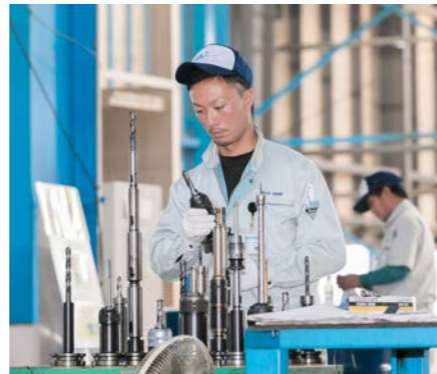
加工に使う工具を選定する。加工方法や寸法によって多種多様な工具を使い分ける
