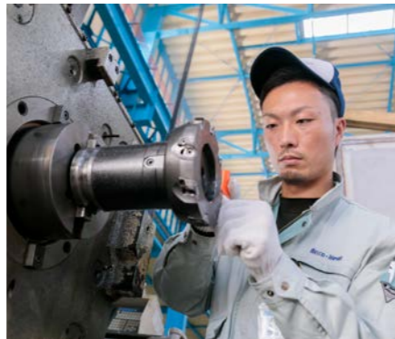
NC加工機に工具を取り付ける。加工精度に影響を及ぼさないように正確に行う
