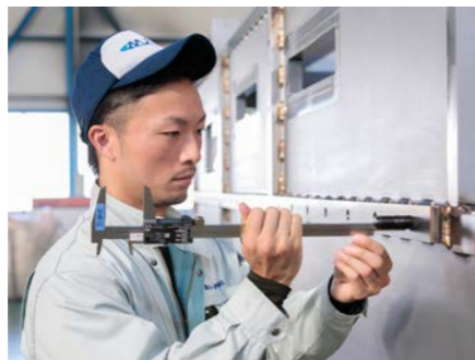
ねじ穴など繊細な部分は、ノギスを使って寸法通りに加工できたかどうか確認する
