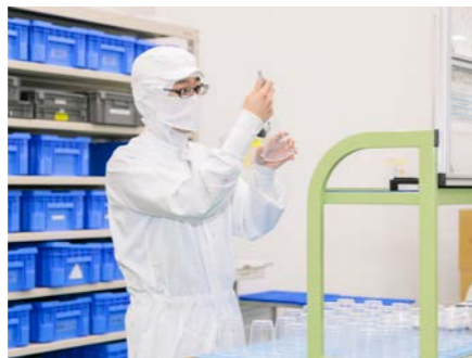
ドリンクカップの検品の様子。器具を使って寸法のズレや形状のゆがみなどがいいかチェックする
