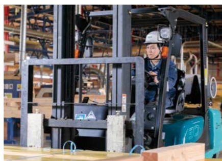
フォークリフトを使って製品を運搬する。製品はシートで梱包され、建築現場に届けられる
