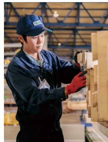
加工を終えた製品にノギスを当てて寸法を測定する。仕口など複雑な部分は、ズレがないか入念に行う
