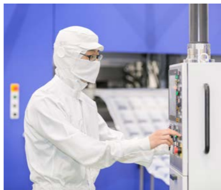
プラスチック容器の成形機を操作する。操作パネルに必要な数値を入力すると自動で成形が始まる
