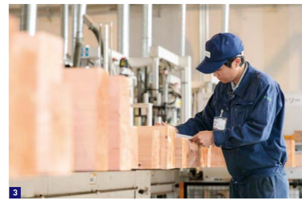
1 プレカットを行う 5 軸加工機の刃物の状態を確認する伊藤一茂さん。同機は縦・横・斜めからの加工が可能で特殊加工を得意としている 2 2 つの構造材の接合部になる仕口 (しくち) も機械が正確に加工するリスト通りに製品が加工されたかチェックする。同工場では 1 日に住宅 12 ~ 13 棟分の木材を加工することができるという
