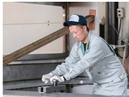
加工する製品を回転させたり固定させたりする「段取り」も、重要な作業の一つだ
