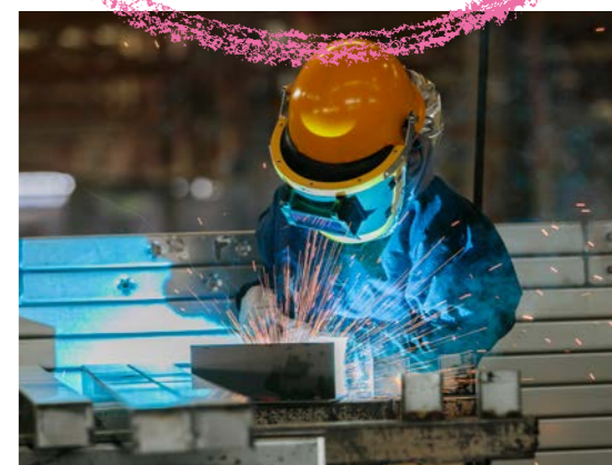
アーク溶接をする戸田真由美さん。アーク溶接とは、空気中の放電現象(アーク放電)を使って、同じ金属同士をつなぎ合わせる溶接法のこと
