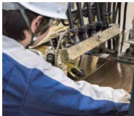
2つのコイルの端同士を溶接機にセットしてつなぎ合わせる
