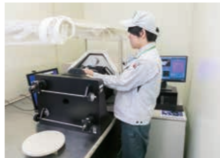
「レーザー干渉計」を使って製品が基準通りに加工されたか測定する
