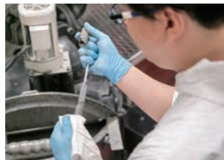
オイルと研磨剤の混合液の状態が基準を満たしているか確認する
