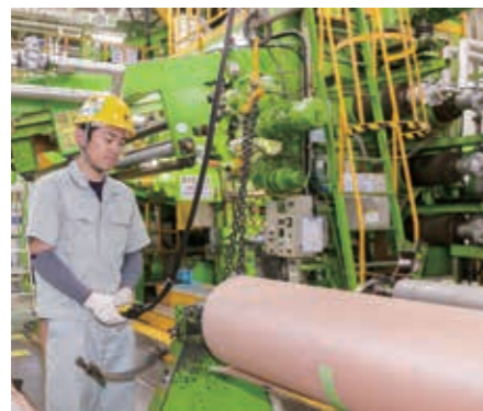
クレーンを使ってゴムシートにはさみ込み帆布を準備
