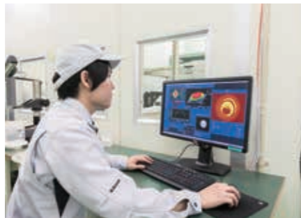
レーザー干渉計の測定結果を確認。超精密な凹凸も視覚的に把握することができる
