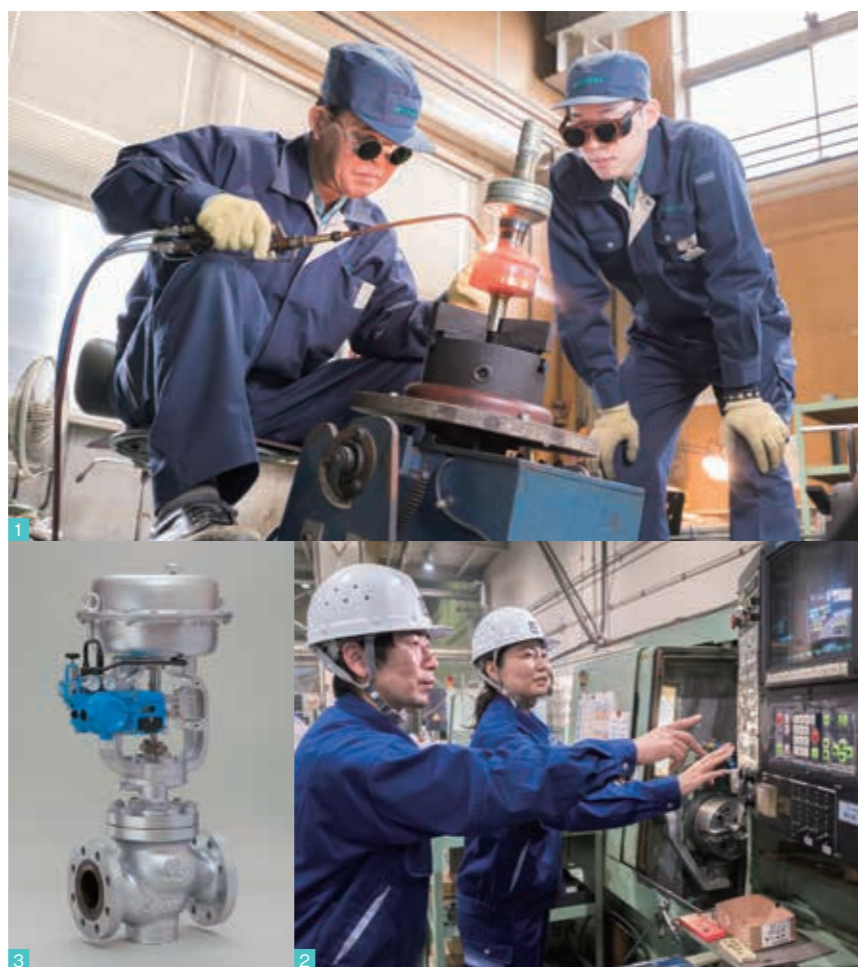
1.ガス溶接(溶着)の実技指導を行う「現代の名工」早坂さん(左)。熟練技を千葉将洋さん(右)が真剣に見守る 2.伊藤佳子さん(右)に数値制御旋盤の技術指導をする1級機械加工技能士の相澤隆介さん(左)。もう一人の名工(庄子恒夫さん、2017年退職)から継承した技術を後進に伝える 3.同社が製造する調節弁。大部分がオーダーメイドで対応するため、高い研究開発技術と製造技術が求められる
