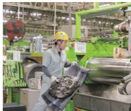
前工程で練られたゴム生地を圧延機に投入する
