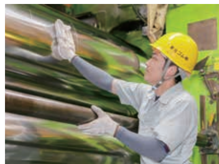
製品の切り替えをする。圧延ロールを丁寧に清掃する
