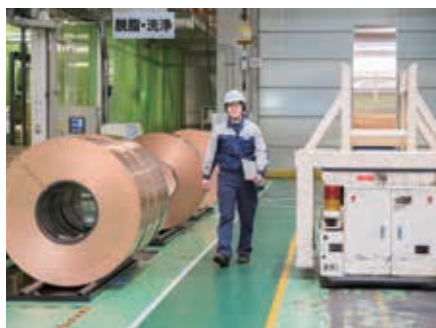
工程間のコイルの移動は、無人搬送車（右）が行う。作業の省人化と安全確保に一役買っている
