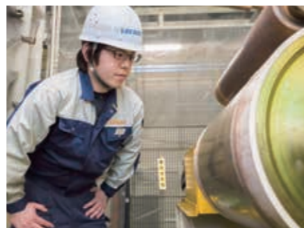
コイルの表面に傷や異物の付着などが見られないか確かめる
