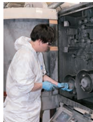
切断機に新しいワイヤをセットする。ポピン部分も合わせて重さ30キロくらいあるという
