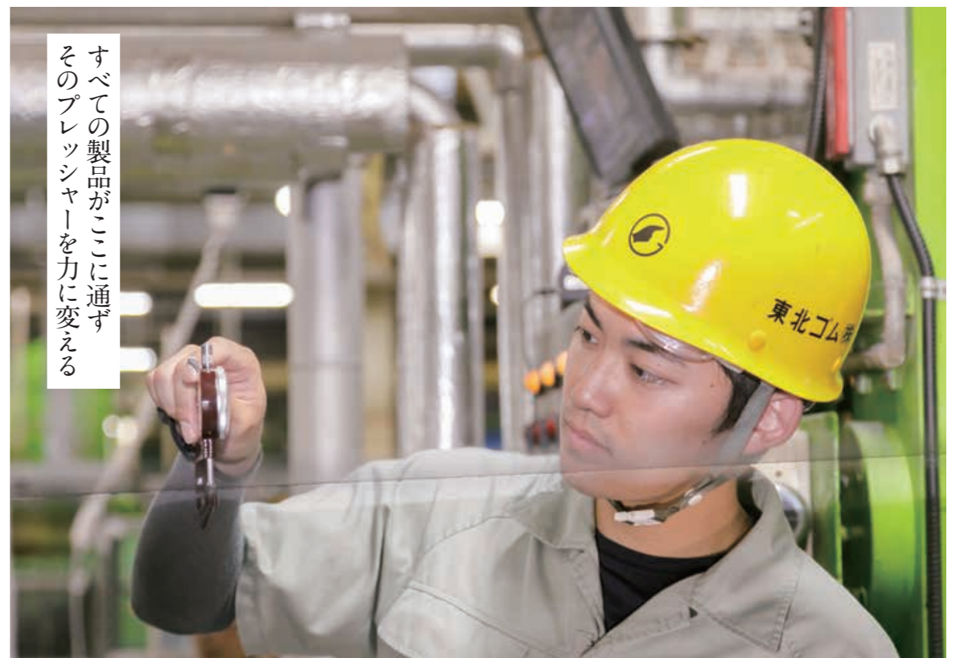
薄く伸ばされたゴムシートの厚さを計測する樋口康平さん
