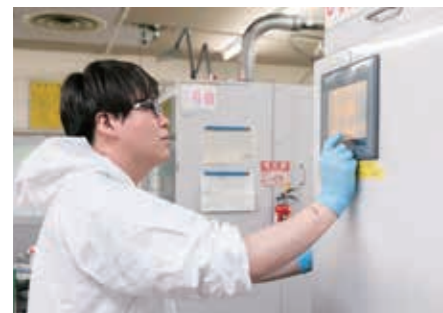
切断機の操作パネルに、台座やワイヤの移動速度などを入力し、機械を稼働させる
