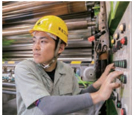
操作盤のスイッチを押し、ゴム生地を圧延を始める
