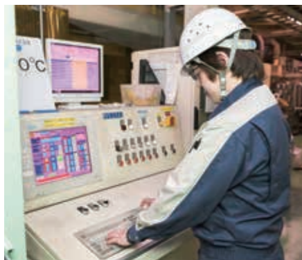
連続焼鈍炉のメイン操作盤にデータを入力して、処理をスタートさせる
