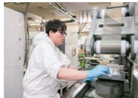
人工水晶を切断機へセットする前に、台座の表面をきれいに清掃する
