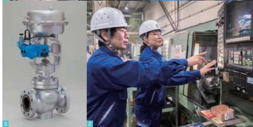
1.ガス溶接(溶着)の実技指導を行う「現代の名工」早坂さん(左)。熟練技を千葉将洋さん(右)が真剣に見守る 2.伊藤佳子さん(右)に数値制御旋盤の技術指導をする1級機械加工技能士の相澤隆介さん(左)。もう一人の名工(庄子恒夫さん、2017年退職)から継承した技術を後進に伝える 3.同社が製造する調節弁。大部分がオーダーメイドで対応するため、高い研究開発技術と製造技術が求められる
