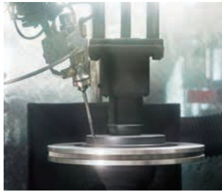
ロボットがテンポよく製品の表面にさび止めの塗装を施していく
