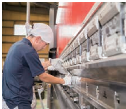
金属を折り曲げる機械で、慎重にステンレス板に曲げ加工を施す
