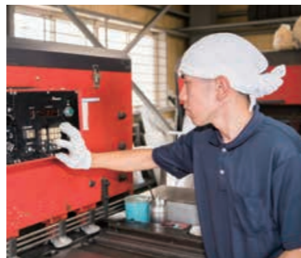
操作盤に数値を入力し、機械を使ってステンレス板をカットする
