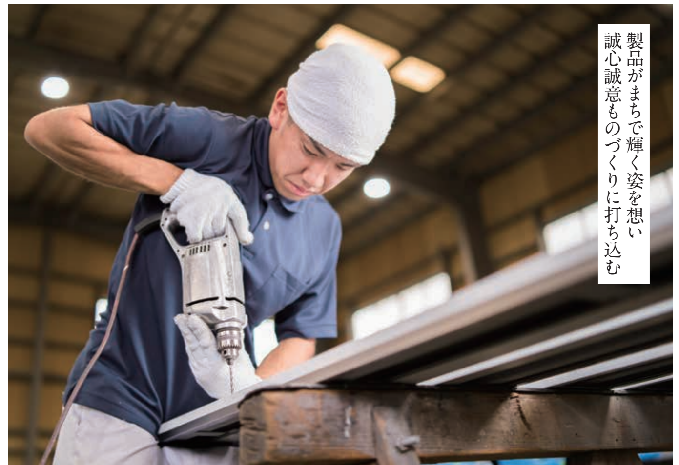
ステンレス製の建材に電動ドリルを使って穴を開ける真壁尚紀さん
