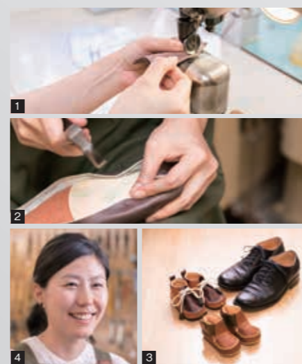
1. 型紙通りに裁断した革のパーツをミシンで縫い合わせる 2. 釘を打ち、靴の上部にあたる革と中底を止める 3. 大人が使うオーダー靴のほか、子どものファーストシューズの注文も受ける 4. 「世界に一つしかない靴を作り続けられるのがオーダー靴製作の魅力」と語る赤松さん
