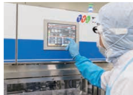
バック詰め装置の操作パネルで設定を行い稼働させる
