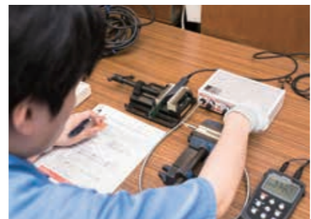
製品に組み込むレーザー制御機器の性能をテストする
