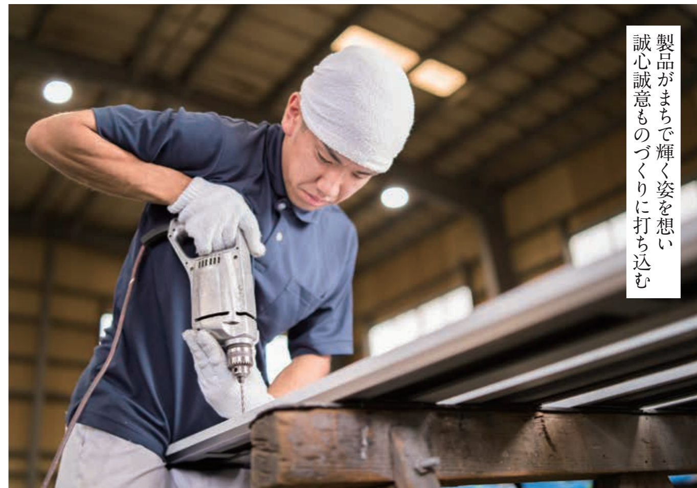
ステンレス製の建材に電動ドリルを使って穴を開ける真壁尚紀さん
