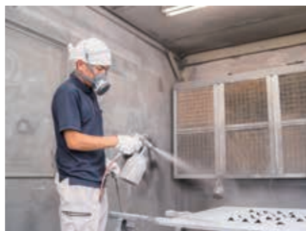
さび止め剤や塗料を吹き付けて製品を塗装する
