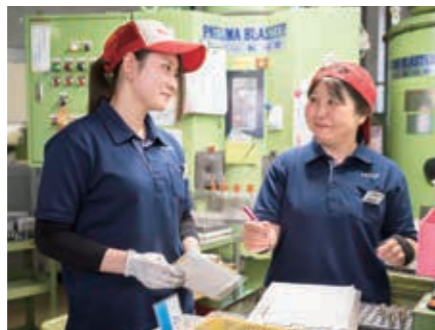
刻印が終わったら、前工程の担当者にもチェックをお願いする。ダブルチェックで不良品の見逃しを防ぐ
