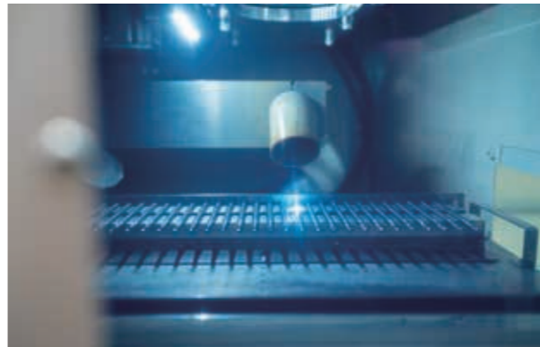
レーザーの光を使って対象物に直接刻印するレーザーマーキングは、小さな文字や複雑なパターンの加工が可能。一度印字すれば半永久的に消えないなどのメリットがある
