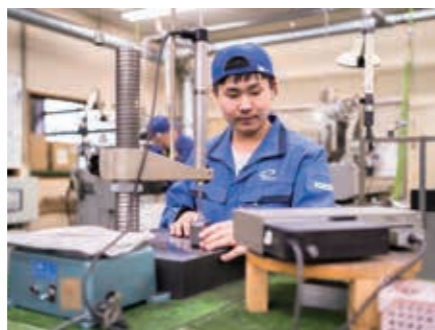
製品の仕上がりを確認するため、測定器で高さをチェックする
