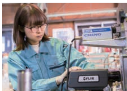
溶けた金属の温度分布を測定する高速度サーモグラフィを設定する
