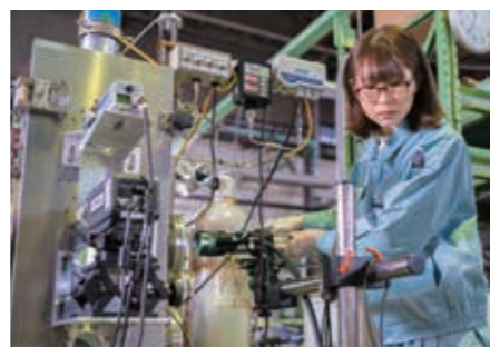
溶けた金属の形状の変化や輝度を測定する高速度カメラを設定する
