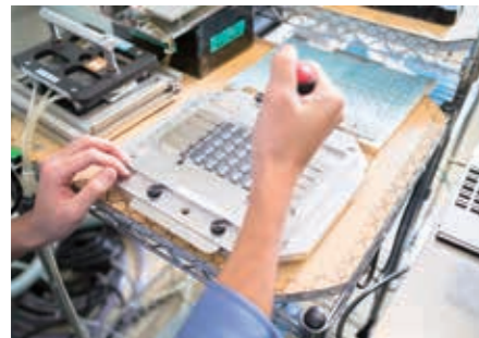
作業の効率化を図るために開発した治具を取り付ける
