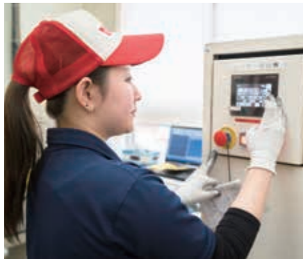
操作パネルを使ってレーザーマーカを稼働させる
