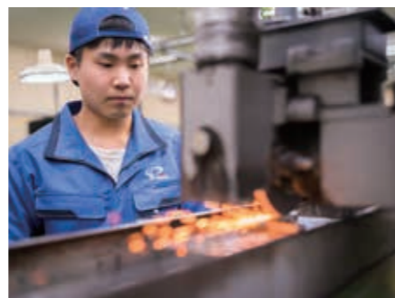
汎用研削盤を使って製品の表面を薄く削り仕上げる
