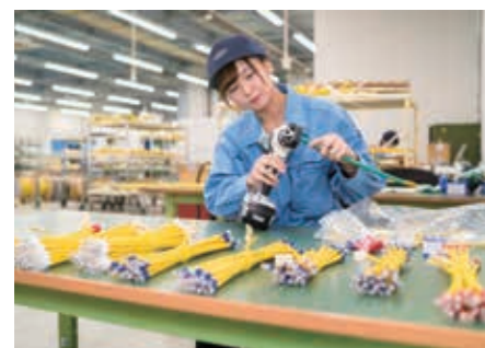
電線に端子を圧着する。一つの盤を作るのには多くの作業が必要だ
