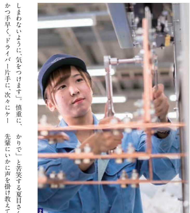
1 身長より高いキャビネットの中の交流分電盤を組み立てるのが、夏目さんの仕事。事前に図面を先輩とチェックする。担当の先輩社員とは常に連携を取りながら作業を進める
