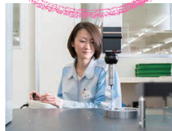
大きな測定機を操って、立体を三次元的に計測。「1000分の1ミリまで正確に測ることができます」
