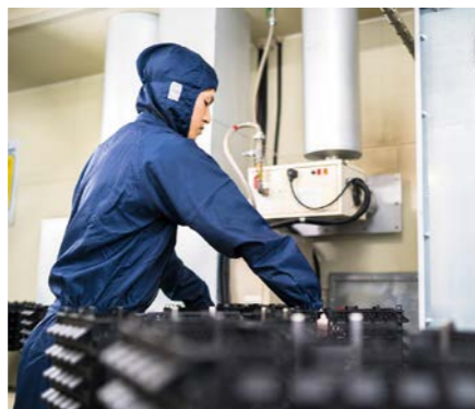
塗装する製品をセットし、自動塗装を行う装置に流す
