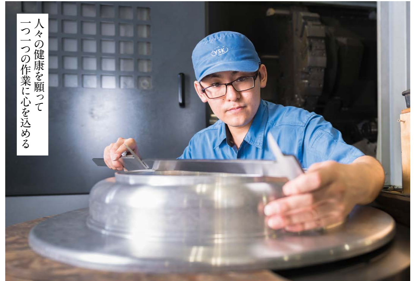
大きなノギスを使って治療椅子の土台に使われる部品の寸法を確認する吉田凌さん
