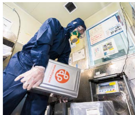
製品ごとに決められたレンピと、条件出しの結果をもとにその日に使う塗料を調合する
