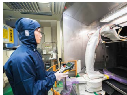
コントローラーを操作して塗装ロボットのティーチングを行う
