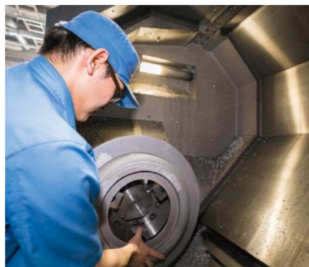
大型のNC加工機から加工を終えた部品を取り出す
