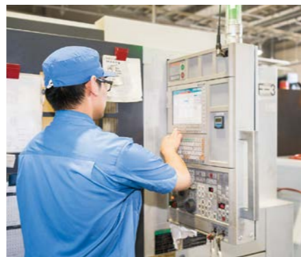
操作パネルにデータを入力してNC加工機を設定する
