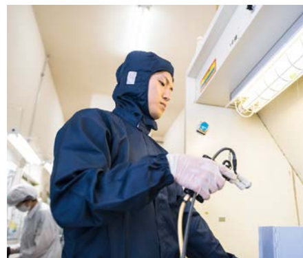
エアガンを使って塗装前の製品のゴミや汚れなどを取り除く
