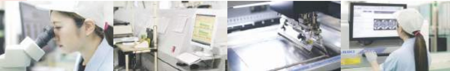
a: 電子顕微鏡を使って細かに製品をチェックする b: 機械を動かすプログラムの微調整も小林さんの仕事だ c: はんだ付けの精度は実は高い d: 外観検査機を使ってはんだ付けの状態を確認中
