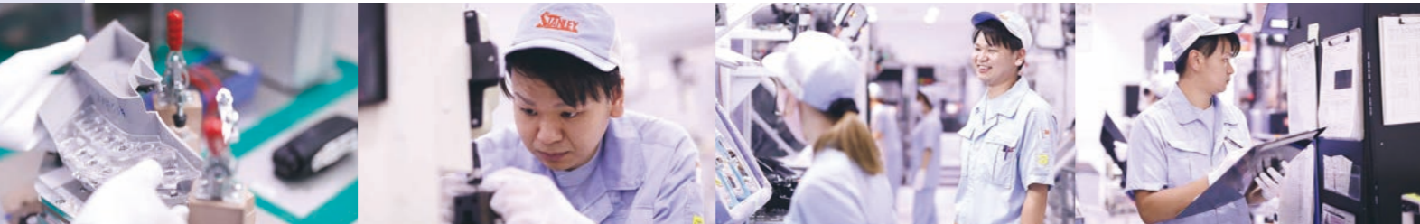
a: 製造したリアコンビネーションランプに問題がないか細かく確認 b: ダンチノギスで車体に取り付けたときの段差を測る c: 持ち前の明るさで積極的に同僚とコミュニケーションを取る d: 生産管理版の記入も大事な役割だ
