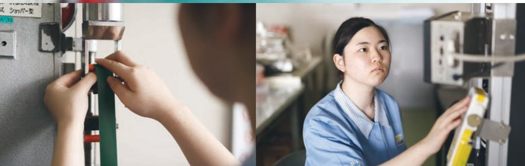
a: 試験用に切片を作るのも熊谷さんら品質保証部の面々が行う b: 工具の扱いも手慣れたもの c: コンテナバッグ生地をショッパー型引張試験機にセットする d: テンションで得られたデータを確認 e: 高校時代電卓部に所属した熊谷さんはテンキーの操作も軽やかだ
