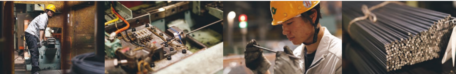
a: 材料を手際よく伸線機に投入していく b: 設備の調整、メンテナンスも重要な仕事だ c: 鋼材の表面を確認する菅原さん d: 指定寸法に整えられた鋼材
