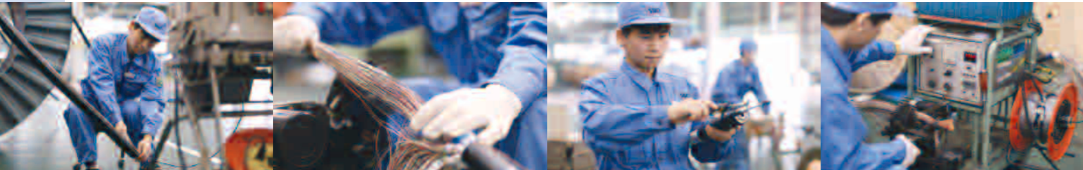
a: ネットワークアナライザーでLCXケーブルの電気特性をチェック b: 検査のため市内電話線路に使用されるPECケーブルの心線を1本ずつほくしていく c: デジタルノギスでケーブル径を確認 d: 混戦試験器に表示される数値を真剣に見つめる高萩さん
