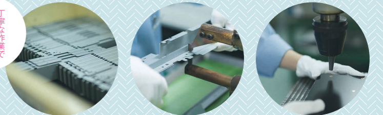
スポット溶接機を使い溶接を行う小竹さん 微妙な力加減を要求される作業だが、 4年目の小竹さんは今まさにスポット溶接工程のエースだ
